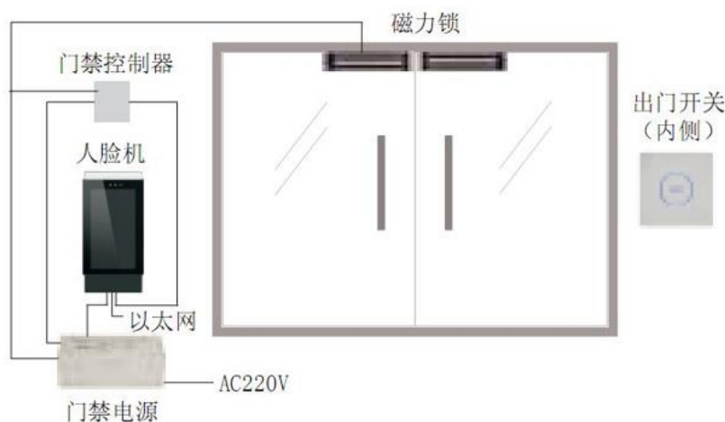
磁力门系统安装示意图
